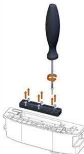
Fase 2. Svitare le 6 viti di fissaggio e sollevare la piastrina
