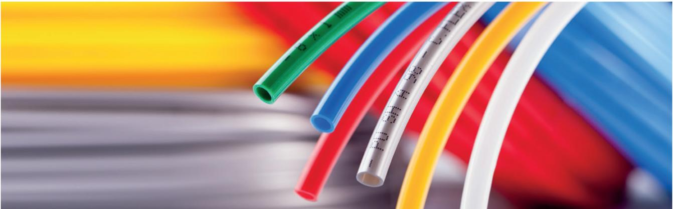
I tubi flessibili **C.FLEX 98** in **poliuretano poliester shore 98 A** sono utilizzati nel 90% delle applicazioni della pneumatica industriale quando la pressione non supera 8 bar. Questi tubi sono apprezzati per la loro grande flessibilità, raggio di curvatura stretto e un'eccellente resistenza alla piegatura.
