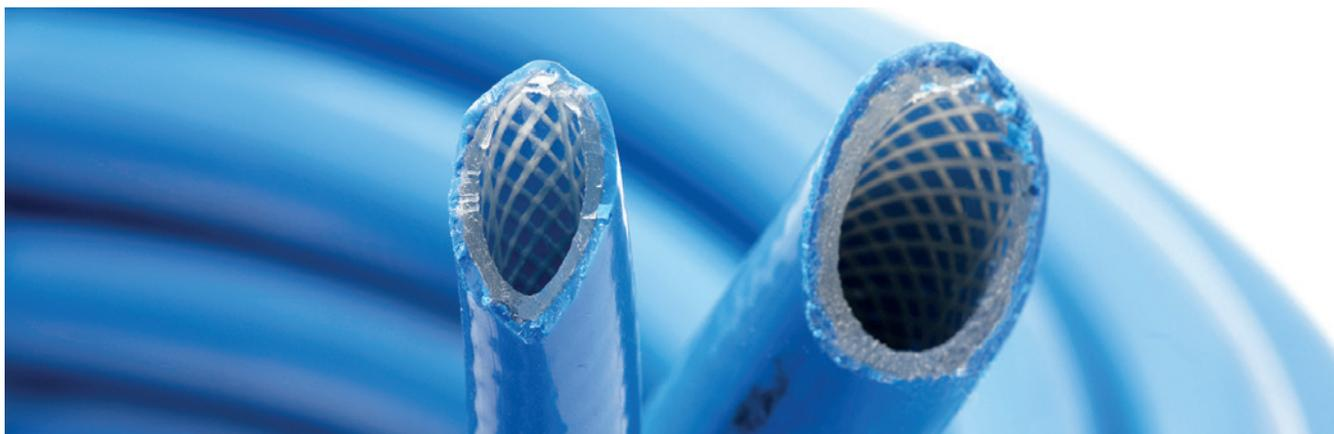
**C.TWENTY:** tubo in poliuretano retinato molto flessibile. Ha una buona resistenza all'abrasione, una flessibilità 5 volte superiore a quella del PVC e grazie alla retinatura in poliestere può essere usato con pressioni di esercizio di 20 bar.
