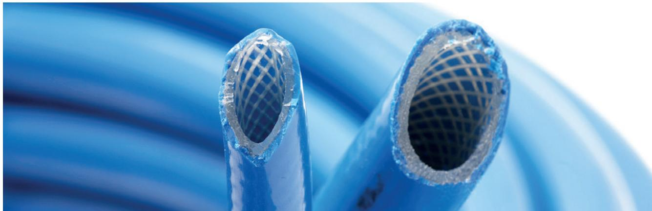
**C.TWENTY:** tubo in poliuretano retinato molto flessibile. Ha una buona resistenza all'abrasione, una flessibilità 5 volte superiore a quella del PVC e grazie alla retinatura in poliestere puo essere usato con pressioni di esercizio di 20 bar.
