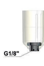
La sede con filetto femmina 1/8, fornibile a richiesta, consente il libero collegamento a sistemi remoti di apertura/chiusura, come elettrovalvole di scarico. È disponibile anche con perno di chiusura con funzione «scarico manuale».
