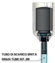
Scarico automatico con funzionamento a galleggiante, apre anche in presenza di pressione al raggiungimento di un certo livello di condensa nella tazza. La condensa in eccesso viene scaricata all'esterno e può essere convogliata collegando un tubo di drenaggio al condotto.
