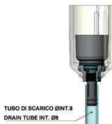
Scarico automatico differenziale, apre anche in pressione solo in presenza di consumo d'aria (min. delta P = 0,2 bar) e al raggiungimento di un certo livello di condensa nella tazza. La condensa in eccesso viene scaricata all'esterno. Possibilità di collegare un tubo di drenaggio al condotto.
