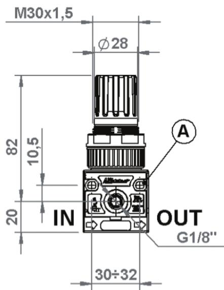
**A** FORI DI FISSAGGIO  $\phi 4,5$
