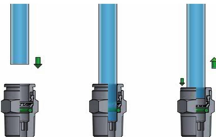
**!** Effettuato il collegamento, assicurarsi che il tubo inserito nel raccordo non sia sottoposto ad alcuna forza di trazione; è necessario inoltre rispettare durante il collegamento del tubo il raggio minimo di curvatura consigliato così come riportato nella sezione tubi di questo catalogo tecnico (vedi pag. 337)
